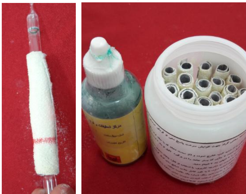
شکل ۸۸: فویل و محلول گرمکن و نصب آن بر روی لوله آشکارساز
