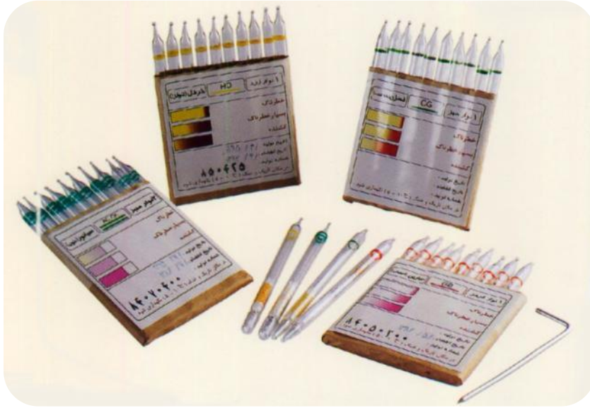
شکل ۹۱: لوله های آشکارساز عوامل شیمیایی
