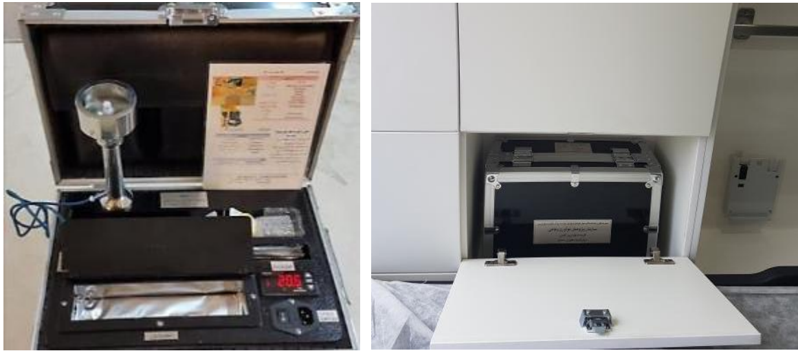
شکل ۱۳: کیف نمونه بردار زیستی و محل استقرار آن
