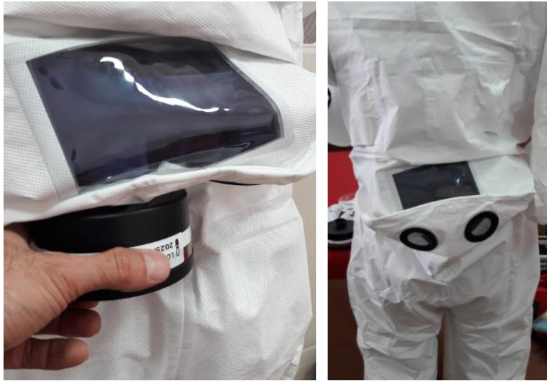
شکل ۶۲: نصب فیلتر پمپ از بیرون لباس
