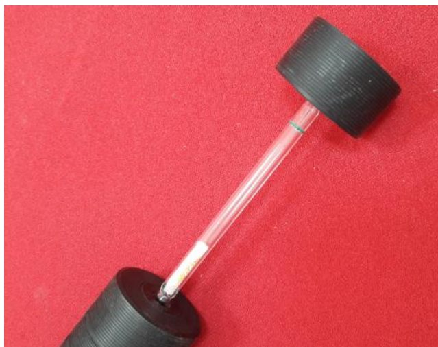
شکل ۹۰: نصب فیلتر بر روی لوله آشکارساز
