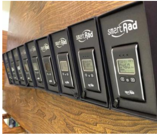
شکل ۴۰: نمونه دستگاه های دزی متر هسته ای
