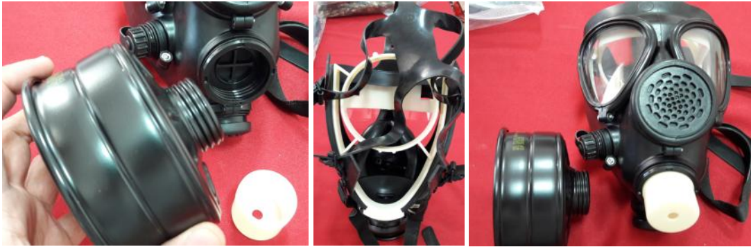
شکل ۹۷: نصب فیلتر بر روی ماسک
