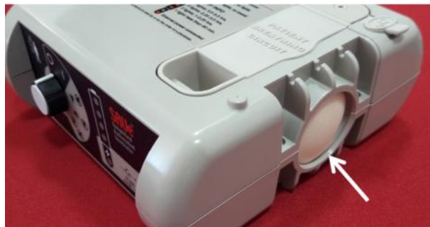
شکل ۳۴: محل نصب فیلتر
