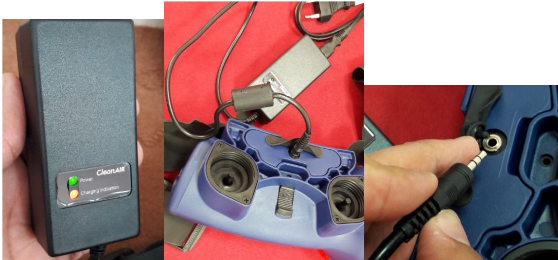
شکل ۷۰: اتصال شارژر به باتری پمپ
