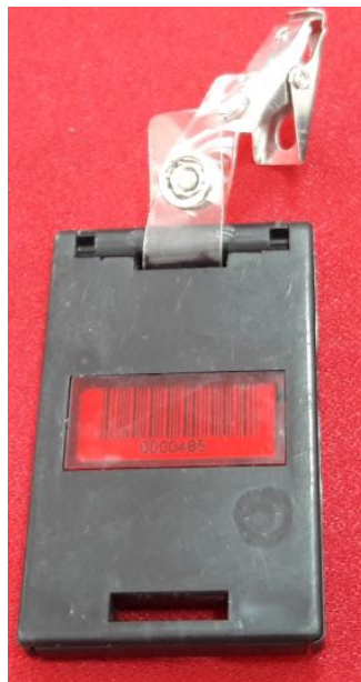
شکل ۳۸: کارت TLD درون آمبولانس
