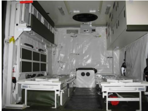
شکل ۱۰: پوشش داخلی آمبولانس توسط شرکت ACD Shelter techniek
