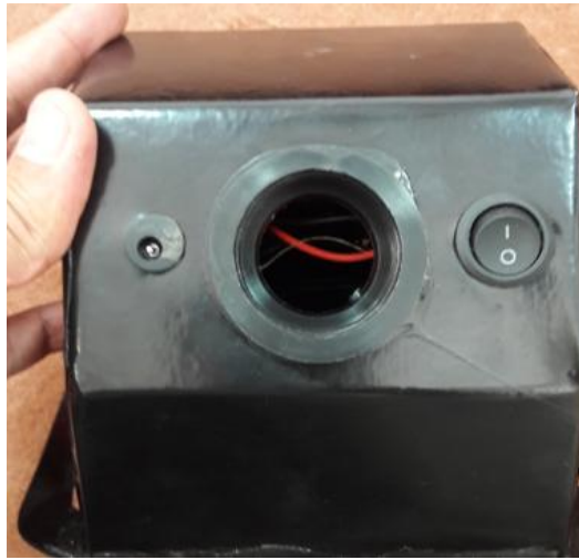
شکل ۲۸: کلید روشن و خاموش و محل سوکت شارژ بر روی پمپ
