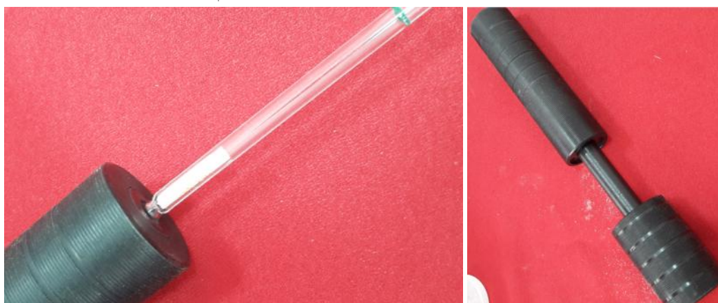
شکل ۸۶: پمپ مکش و طریقه قرار دادن لوله درون آن
