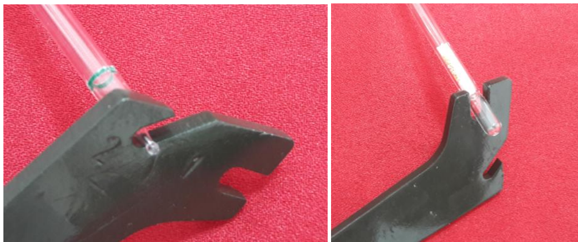
شکل ۸۷: آچار مخصوص شکستن لوله ها
