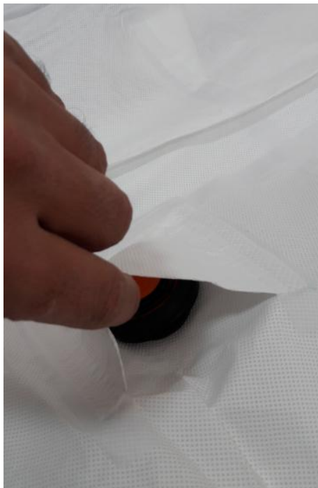
شکل ۶۷: سوپاپ یکطرفه خروج هوا
