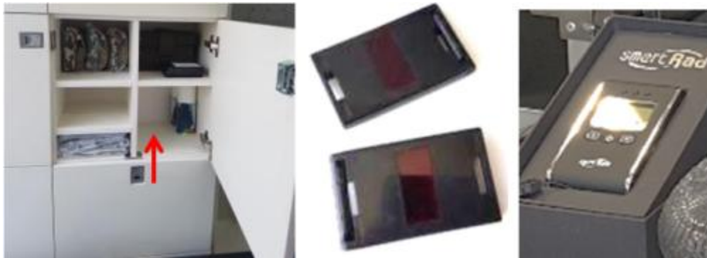
شکل ۳: دزی متر و کارت TLD و مکان قرارگیری
